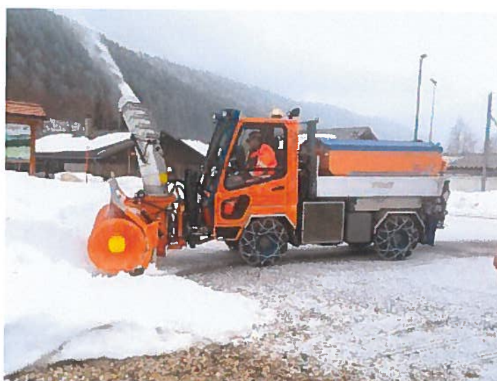
Véhicule Meily 1300 équipé de la fraiseuse Zaugg SF 72-70-160
